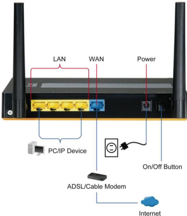
2. Adesso l'installazione è completata. Si può iniziare a configurare il dispositivo.
