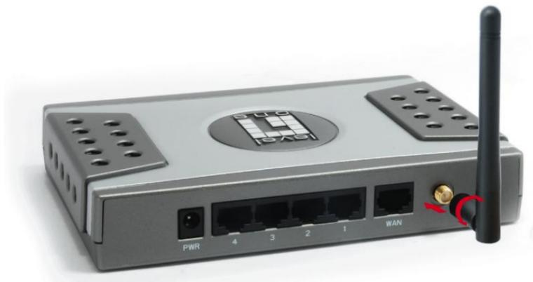
2. Sluit uw breedband internetverbinding aan op de WAN-poort van uw WBR-6003.
