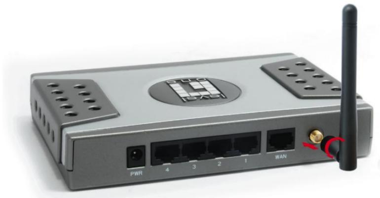
2. Conecte su conexión a Internet de banda ancha al puerto WAN del dispositivo WBR-6003.
