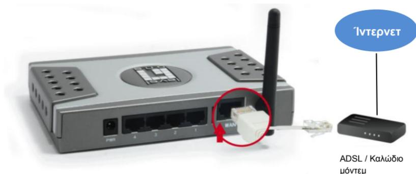
3. Συνδέστε το καλώδιο LAN του υπολογιστή.
