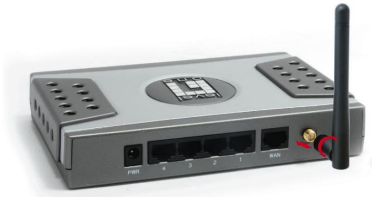
2. Подсоедините кабель широкополосного доступа в Интернет к порту «WAN» на маршрутизаторе WBR-6003.
