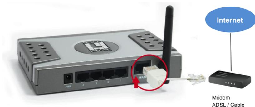
3. Conecte el cable de red LAN del equipo.
