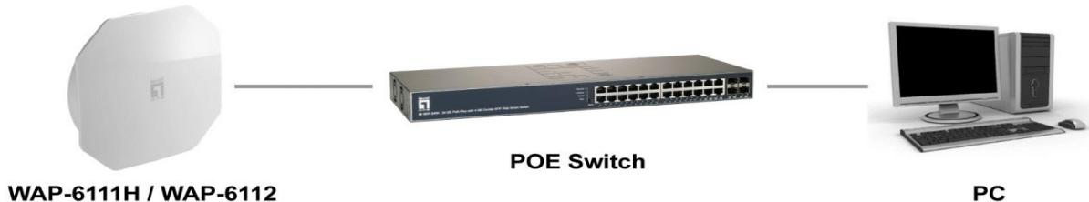
2. Συνδέστε το σημείο πρόσβασης σε ένα WAC-1000/WAC-1001. Συνδέστε τον υπολογιστή σας στο ίδιο δίκτυο με αυτό του WAC-1000/WAC-1001. Προβείτε σε διαχείριση του σημείου πρόσβασης από τον υπολογιστή μέσω του WAC-1000/WAC-1001. (για λειτουργία FIT AP)
