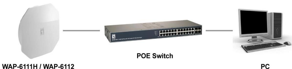
2. Connettere l'access point a WAC-1000/WAC-1001. Connettere il computer alla stessa rete di WAC-1000/WAC-1001. Gestire l'access point dal computer tramite WAC-1000/WAC-1001 (per modalità FIT AP).
