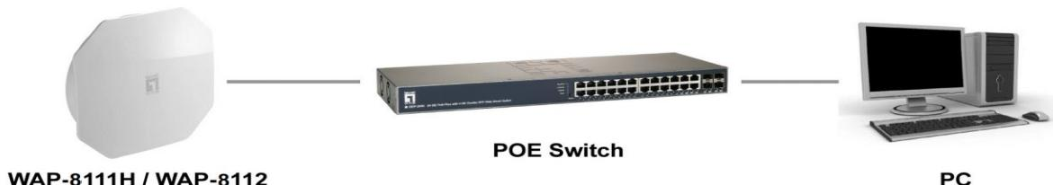
2. Συνδέστε το σημείο πρόσβασης σε ένα WAC-1000/WAC-1001. Συνδέστε τον υπολογιστή σας στο ίδιο δίκτυο με αυτό του WAC-1000/WAC-1001. Προβείτε σε διαχείριση του σημείου πρόσβασης από τον υπολογιστή μέσω του WAC-1000/WAC-1001.(για λειτουργία FIT AP)
