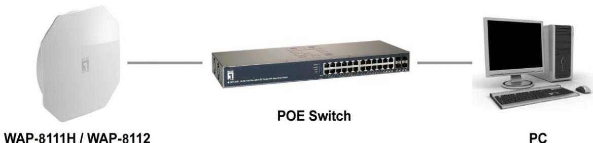
2. Collegare l'access point a WAC-1000/WAC-1001. Collegare il computer alla stessa rete di WAC-1000/WAC-1001. Gestire l'access point dal computer tramite WAC-1000/WAC-1001 (per modalità FIT AP).
