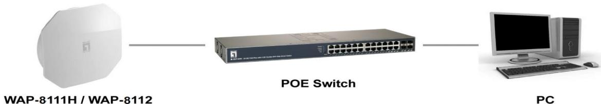
2. Подключите точку доступа к устройству WAC-1000/WAC-1001. Подключите компьютер к одной сети с устройство WAC-1000/WAC-1001. После этого осуществляйте управление точкой доступа с компьютера через устройство WAC-1000/WAC-1001 (в режиме точки доступа FIT).
