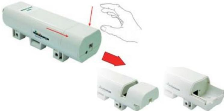
Verbinden Sie das Cat.5/5e/6 Kabel mit dem RJ-45 Port.
