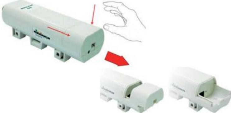
2. Podłącz kabel kat.5/5e/6 do portu RJ-45.
