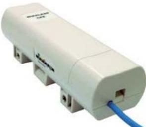
4. Steek het voedingsnoer in de DC-aansluiting van de PoE-injector
