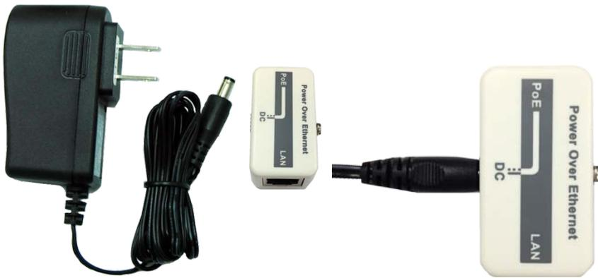
5. Συνδέστε την άλλη άκρη του καλωδίου δικτύου (Cat.5/5e/6) του AP, στην θύρα POE της συσκευής PoE Injector. (Στην συνέχεια θα χρειαστείτε σαφώς ένα δεύτερο καλώδιο δικτύου για την σύνδεση από τη θύρα LAN της συσκευής PoE Injector, στο τοπικό σας δίκτυο (switch, hub)). Τέλος συνδέστε το τροφοδοτικό στην πρίζα ρεύματος.
