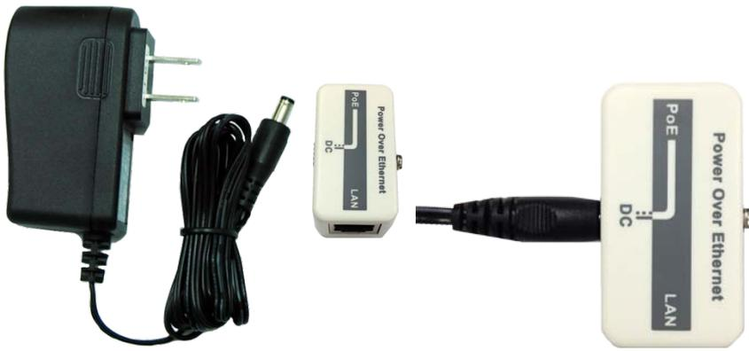
5. Assemblez les éléments préparés aux étapes 3 et 4 en branchant l'autre extrémité du câble Cat.5/5e/6 de l'étape 3 sur le port PoE de l'injecteur PoE de l'étape 4. Une fois l'étape 5 terminée, l'ensemble complet a l'apparence ci-dessous.
