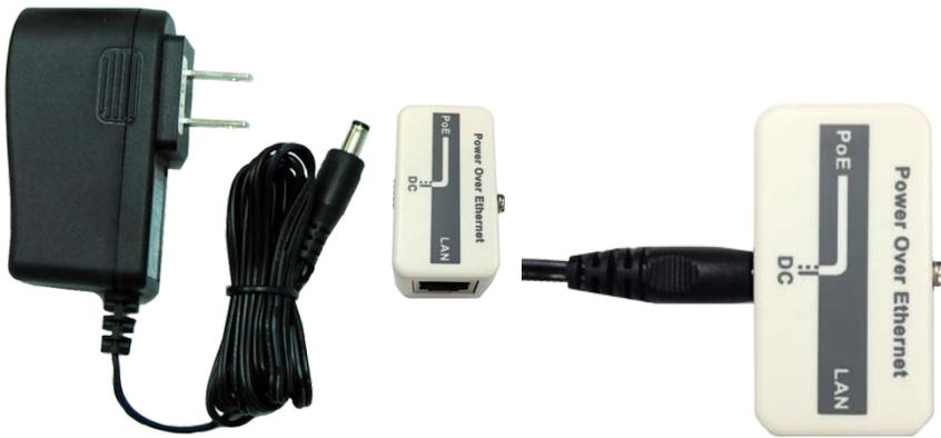
5. Breng de delen uit stap 3 en stap 4 bij elkaar door het andere uiteinde van de Cat.5/5e/6 kabel in stap 3 te steken in de PoE-aansluiting van de PoE-injector uit stap 4. Is stap 5 voltooid, dan ziet het geheel er als volgt uit.
