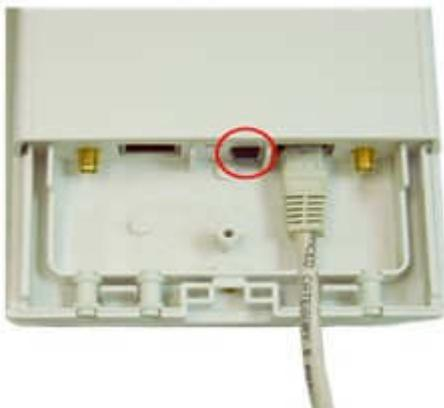
4. Befestigen Sie das Gehäuse mit der mitgelieferten Schraube auf der Halterung.
