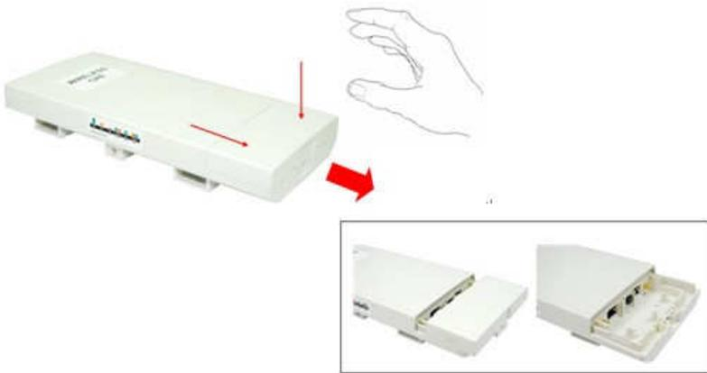
2. Stecken Sie ein Cat.5/5e/6 Kabel in den RJ45 LAN1-Port. Verwenden Sie NICHT den RJ45 LAN2-Port.
