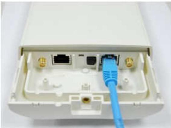
3. Stellen Sie die Stromversorgung an, indem Sie die schwarze PWR-Taste neben dem LAN1-Ethernet-Port drücken.
