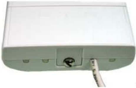
5. Stecken Sie das Stromkabel in den DC-Port des PoE-Injektors.
