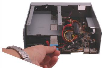
Anbring harddiskdrevet på bakken og skub den ind for at sikre harddiskdrevet.
