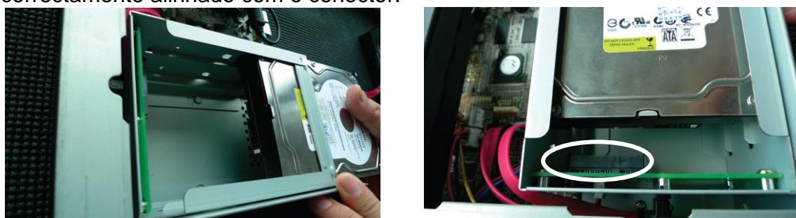
4. Fixe a unidade de disco rígido utilizando o parafuso fornecido.
