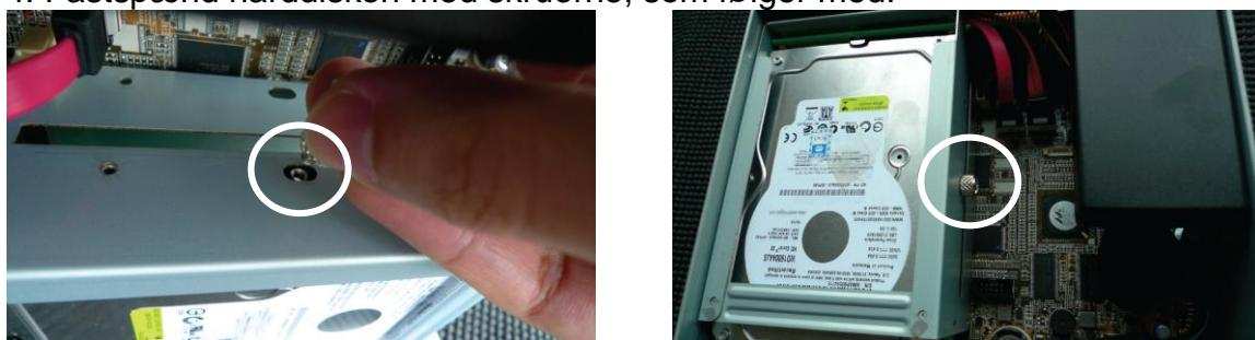
5. Sæt den øverste del af kabinetet på igen, og spænd det sammen med den nederste del af kabinetet.
