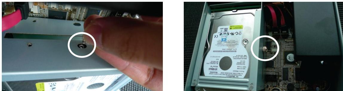
5. Remettez le châssis supérieur en place et fixez-le au châssis inférieur.
