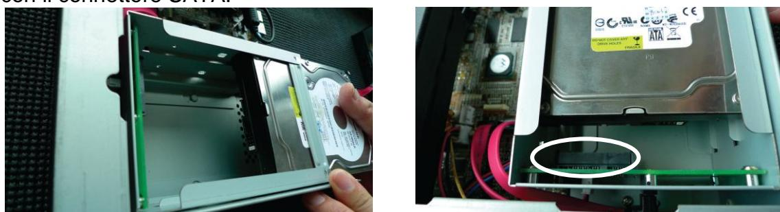
4. Fissare l'unità HDD usando la vite fornita in dotazione.
