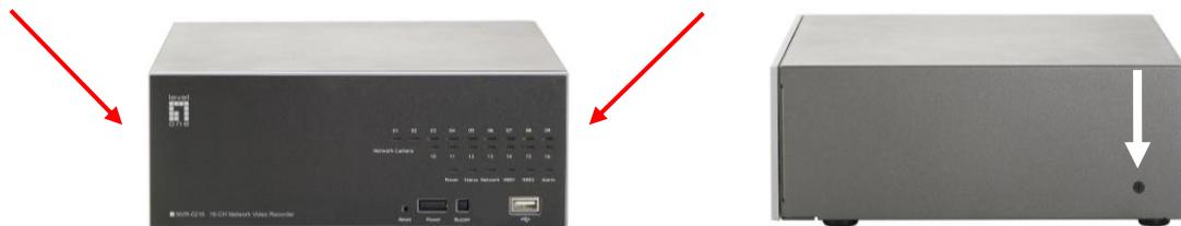
2. Tire hacia delante de la cubierta superior y, a continuación, levántela.
