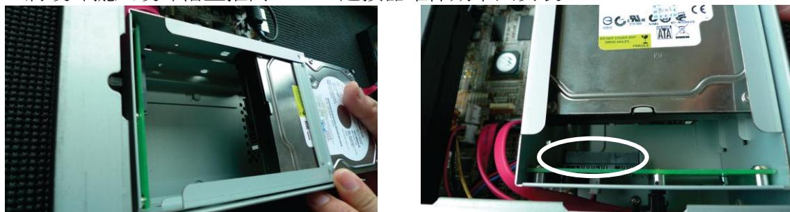
4. 使用螺絲把硬碟鎖上硬碟槽。
