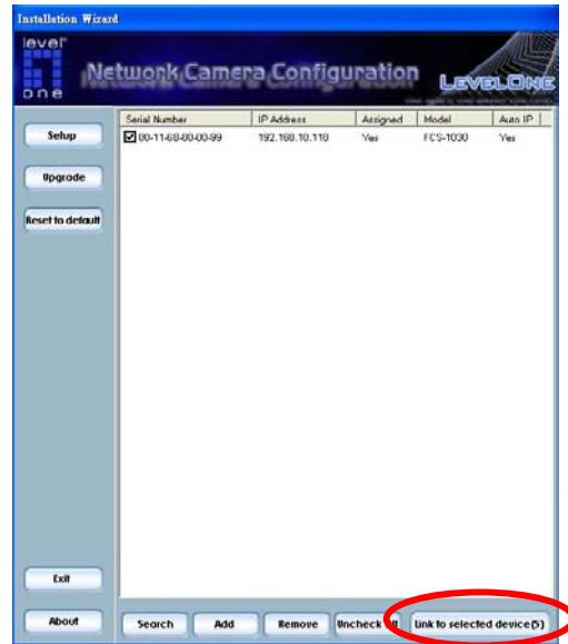
В случае успешного соединения с камерой, откроется окно контроля доступа. Имя пользователя по умолчанию: «**root**». Пароль по умолчанию: совпадает с **MAC адресом** камеры. MAC адрес камеры отображен на этикетке, размещенной на подставке. MAC адрес следует вводить прописными буквами.
