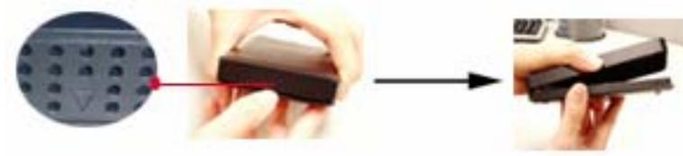
2. 將硬碟插入IDE插槽。您必須平行地將硬碟插入底座上的IDE插槽。請勿不當施力於硬碟接腳，也不要以斜角的方式將硬碟插入插槽內，以免損害硬碟接腳。
