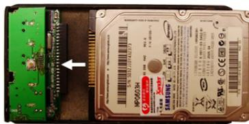
3. 將底座的銀色螺絲拴緊，以固定硬碟。
