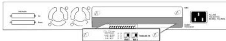
*Figure 3.2 Insert the Module*
