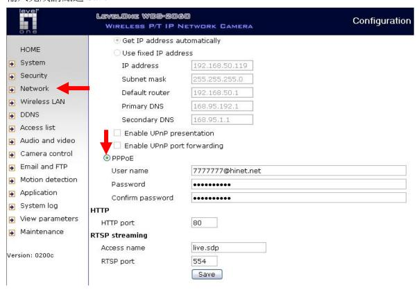
設定完 LevelOne IP 網路攝影機,請把 IP 網路攝影機單接到 ADSL Modem 後電源重新插拔一次參考圖解
