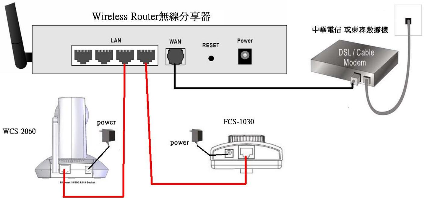
使用 IP Camera 請先接入 RJ-45 網路線再插入電源。
