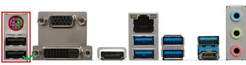
Nutzen Sie bei oben abgebildetem Anschluss ausschließlich den USB-Stecker, um Maus + Tastatur, wie unten abgebildet mit dem KxM und dem ACC-210x zu verbinden.
