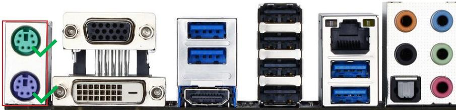
Nutzen Sie bei oben abgebildetem Anschluss den beiliegenden PS2 zu USB-Adapter, um beide PS2 Anschlüsse, wie unten abgebildet mit dem KxM und dem ACC-210x zu verbinden.
